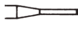
Zylinder, Stirn belegt Cylinder, End Cutting Only Cilíndrico con revestimiento en la punta 25
